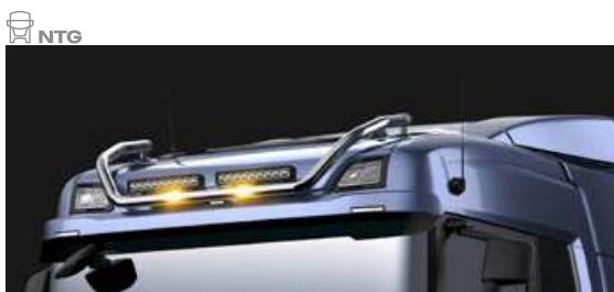
**Scania Lichtgruppen für normale Dächer, kurze Ausführung mit LED-Stroboskopblitzleuchte**
