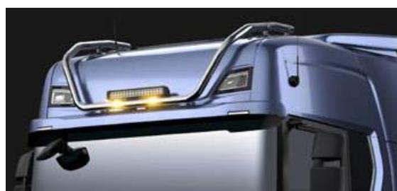
**Scania Lichtgruppen für Hochdach, kurze Ausführung mit LED-Stroboskopblitzleuchten**
