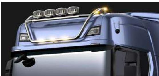
**Scania Lichtgruppe für hohes Dach, kurz mit Styling-LED und Leuchtenhaltern in hoher Position**
