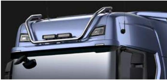
**Scania Dach-Scheinwerferbügel für hohes Dach, kurze Ausführung ohne LED**
