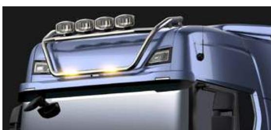
**Scania Lichtgruppe für hohes Dach, kurz mit LED-Stroboskopblitzleuchten und Leuchtenhaltern in hoher Position**
