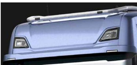
**Dachlichtgruppen-Satz, Ausführung Airflow für hohes und normales Dach**
