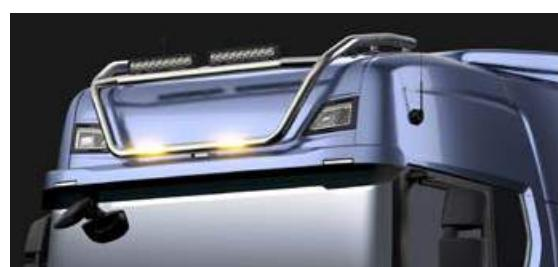
**Scania Lichtgruppe für hohes Dach, lang mit LED-Stroboskopblitzleuchten und Leuchtenhalter in hoher Position**
