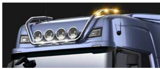
**Scheinwerferbügelsatz, lange Ausführung, mit LED für hohes Dach und inkl. 4 Scheinwerfer Hella Luminator**
