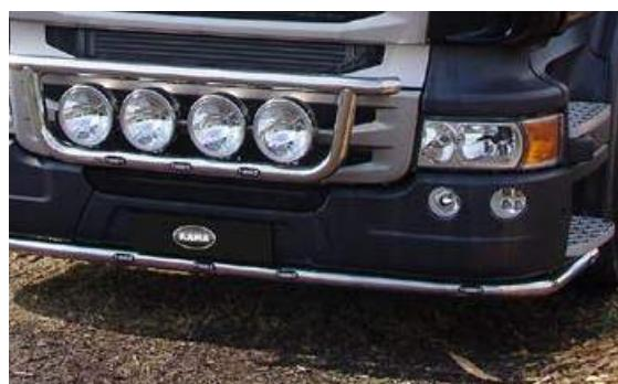
Frontrohr mit LED, Baureihen G und R mit niedrigem
