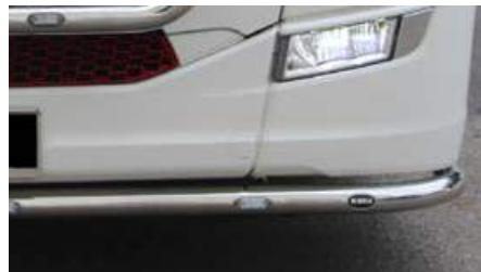
**Frontrohr, für hohe Stoßfänger, mit LEDs**
