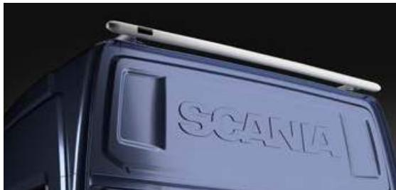
**Dachbügel-Satz, Ausführung Airflow, nach hinten gerichtet**
