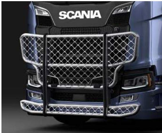
**Frontschutzsystem, Bausatz Trux Highway Airflow**
